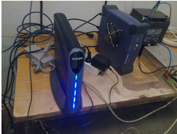
Слика 24. Сателитски модем са уређајем за стално напајање
